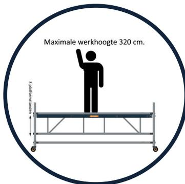
Plate-forme utilisable sur 3 hauteurs, ce qui permet d'atteindre une hauteur de travail maximale de 320 cm.
