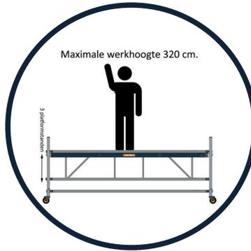
Die Plattform kann in 3 Höhen eingesetzt werden und ermöglicht eine maximale Arbeitshöhe von 320 cm.
